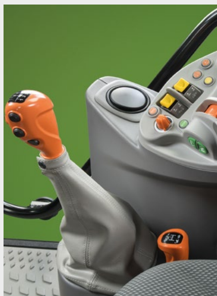
↑ Ovládání převodovky Powershift s funkcí APS.
