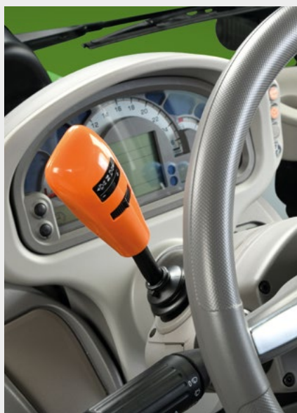
↑ Elektrohydraulický reverzor pojezdu PowerShuttle s nastavitelnou odezvou.
