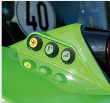
↑ Vnější ovládání zadního třibodového závěsu a PTO.
