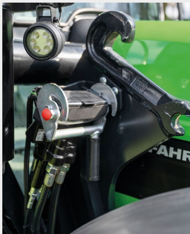
↑ Pevný rám čelního nakladače s připojením Hydro-Fix.
