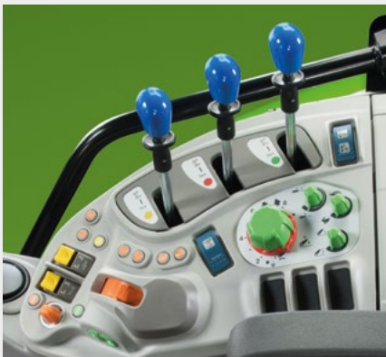
↑ Ergonomické rozložení ovládacích prvků zadního třibodového závěsu a ovládání hydrauliky.
