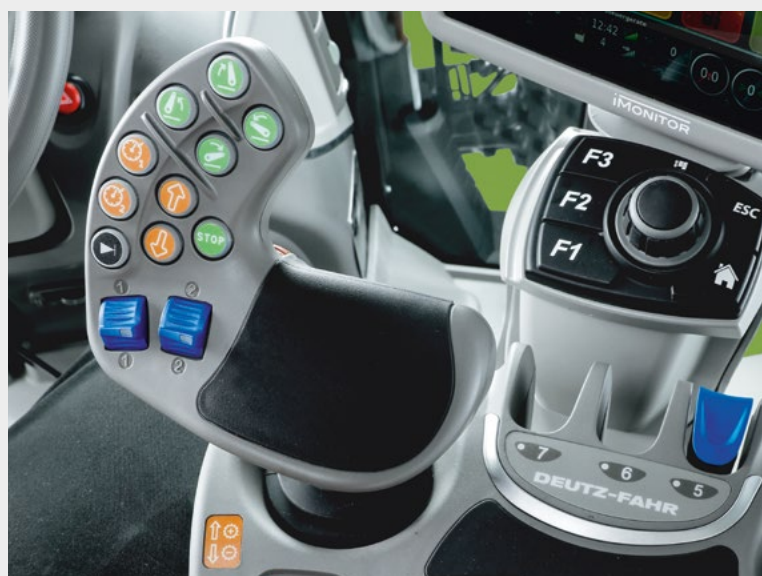
↑ Ergonomický MaxCom joystick s ovládáním předního a zadního třibodového závěsu, motoru, převodovky, souvratového managementu a dvou proporčních hydraulických okruhů.
