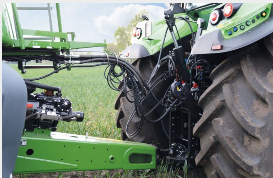
↑ Zadní tříbodový závěs v přepravní poloze pro menší riziko kontaktu se spodním táhlem při zatáčení.
