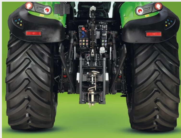
↑ Zadní tříbodový závěs, pět zadních hydraulických okruhů, vnější ovládací prvky na blatníchích na obou stranách.
