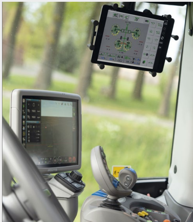
↑ Funkce Xtend umožňuje zobrazovat SDF systém automatického navádění, nebo ovládat nářadí ISOBUS na externím zařízení např. na tabletu.
