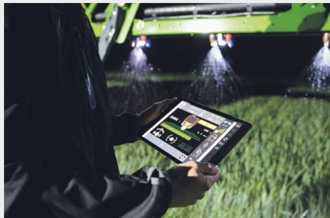
↑ Funkce Xtend s tabletem, ovládání nářadí přes ISOBUS UT, když jste mimo kabinu.
