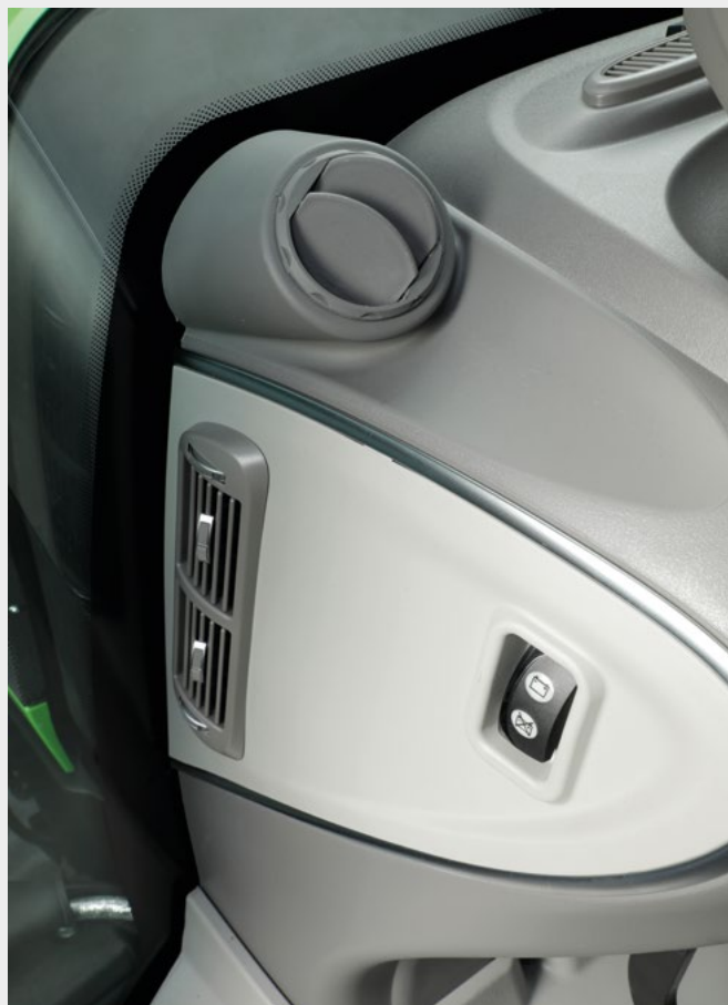
↑ Přidavné vzduchové výdechy a hlavní vypínač baterie pohodlně umístěné v kabině.
