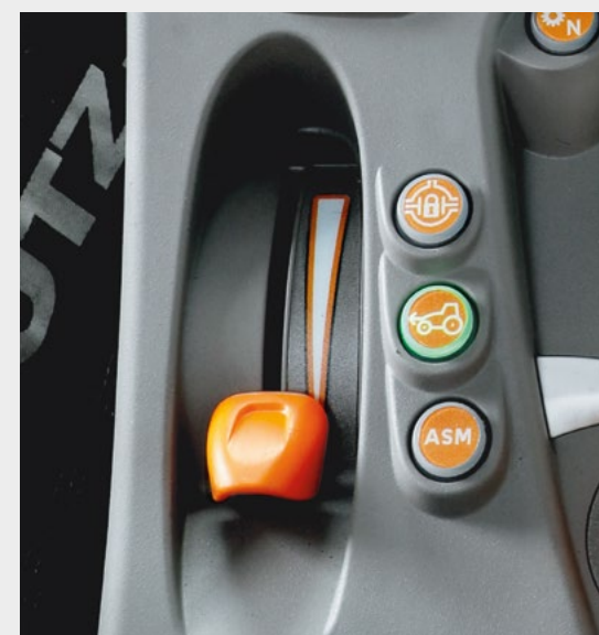
↑ Nezávislý ruční plyn a elektrohydraulická aktivace uzávěrek diferenciálů, pohonu všech kol a ASM automatické funkce.
