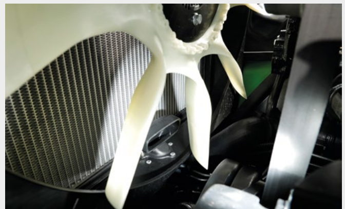
↑ Elektronický viskózní ventilátor (eVisco) se sací hadicí pro systém předčištění vzduchového filtru.
