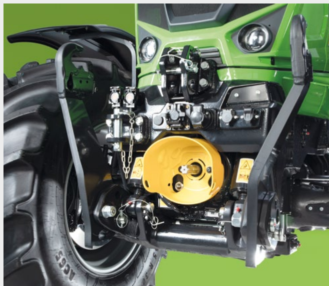
↑ Přední tříbodový závěs s nosností 5.450 kg a přední vývodovou hřídelí DualSpeed.
