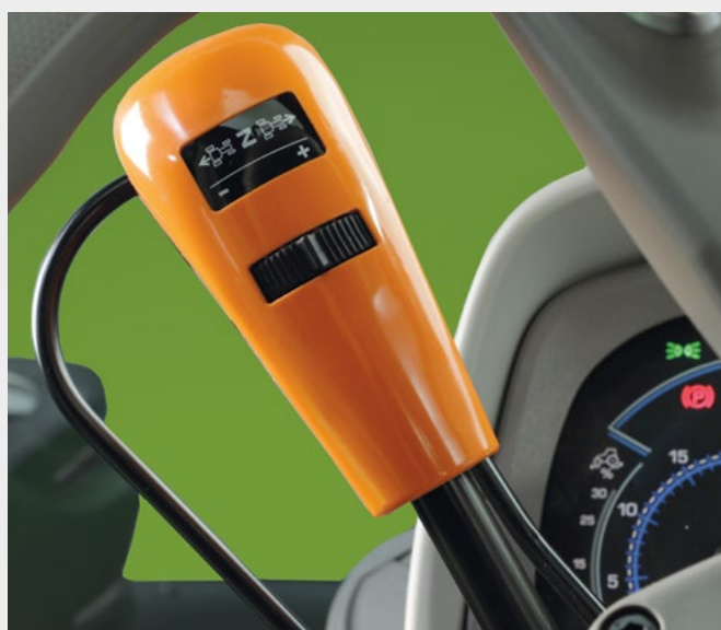
↑ PowerShuttle s nastavením citlivosti SenseClutch v pěti stupních.
