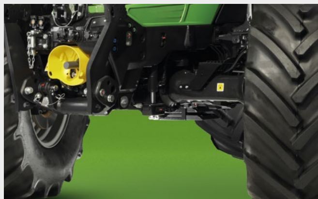
↑ Koncepte předního odpružení s vysokou světlovou výškou se třemi nastavitelnými úrovněmi v monitoru InfoCenter PRO .
